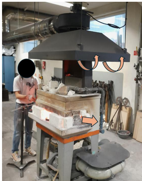
Les flèches indiquent les flux d'air échappant à la captation.
